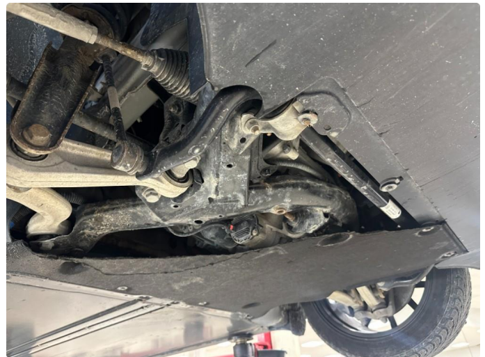
1.1 Liten skade i beskyttelsesplate under bil
