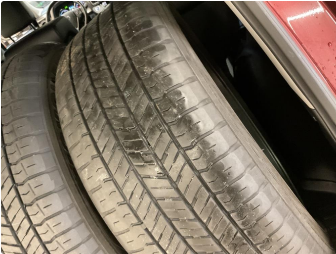
1.2 Skjev slitasje på sommerdekk
