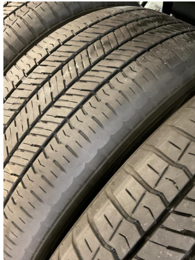
1.2 Skjev slitasje på sommerdekk
