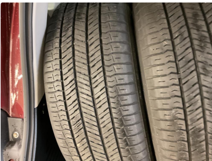
1.2 Skjev slitasje på sommerdekk
