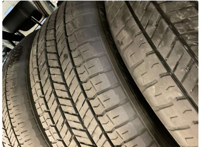
1.2 Skjev slitasje på sommerdekk
