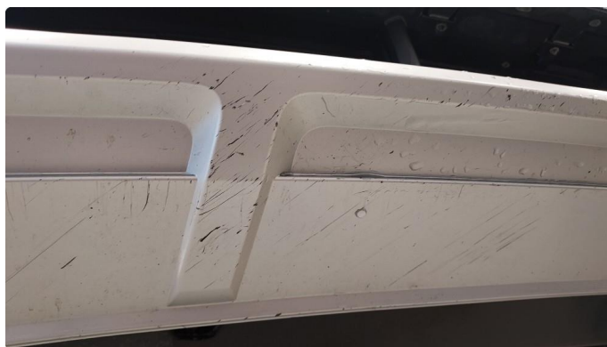
1.5 Noe oppripet på underside av fanger foran
