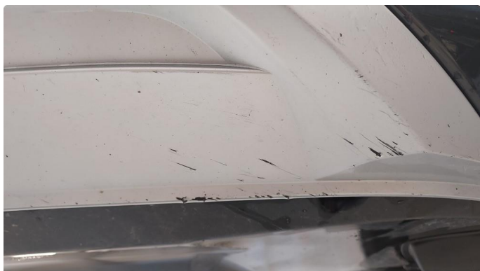
1.5 Noe oppripet på underside av fanger foran
