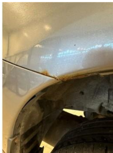
1.2 Litt rust i skjerm/hjulbue venstre bak
