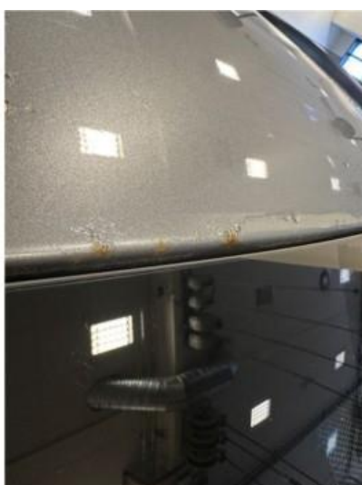
1.5 Noen steinsprut i forkant tak
