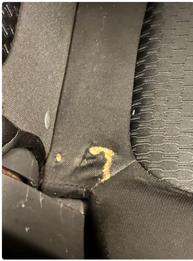
2.1 Rift i setetrekk høyre bak
