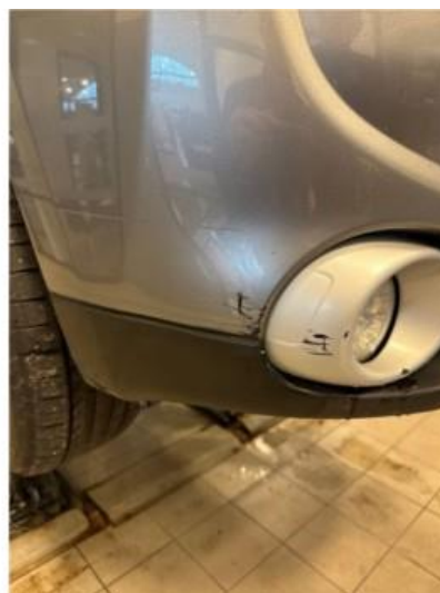
1.4 Litt oppripet på nedre del av fanger høyre foran
