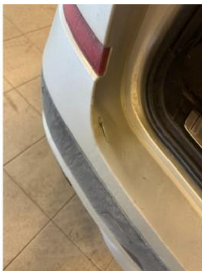
1.3 Sprekk i innlastningssone
