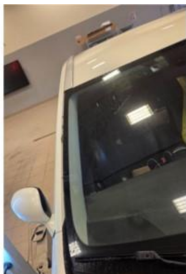
1.3 Noe flass av lakk ved frontrute, pensles
