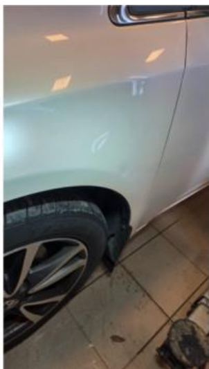
1.1 Liten parkeringsbulk på venstre framskjerm
