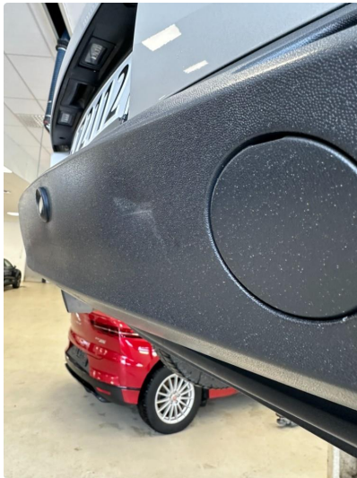
1.1 Noen små bulker i fanger bak
