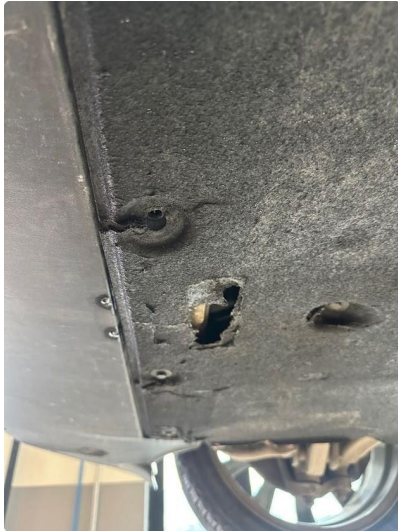
1.1 Noen hull i beskyttelsesplate under motor
