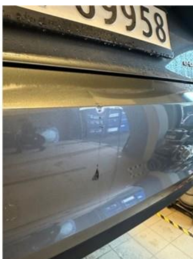
1.3 Liten skade i fanger bak
