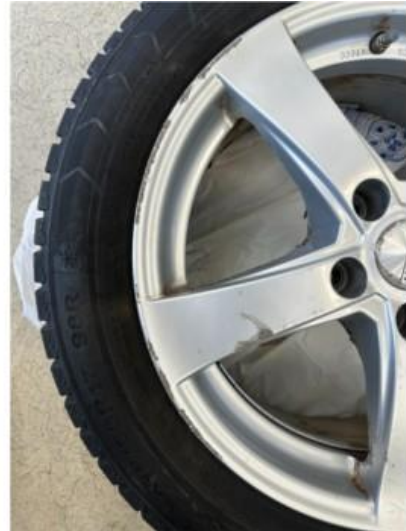
1.2 En vinterfelg litt kantkjørt
