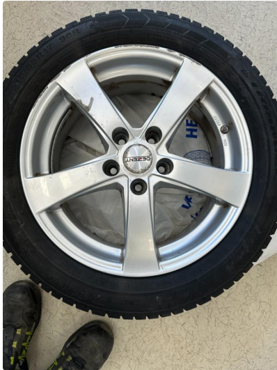
1.1 Påbegynnende oksidering på alle vinterfelger. Normal slitasje
