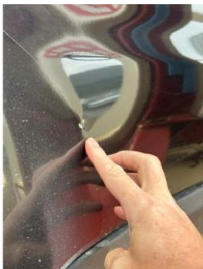
1.1 Liten p.bulk/lakkskade i dør høyre bak
