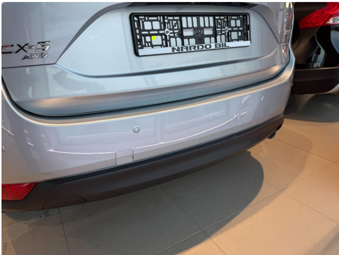
1.1 Bulk og riper støtfanger bak.
