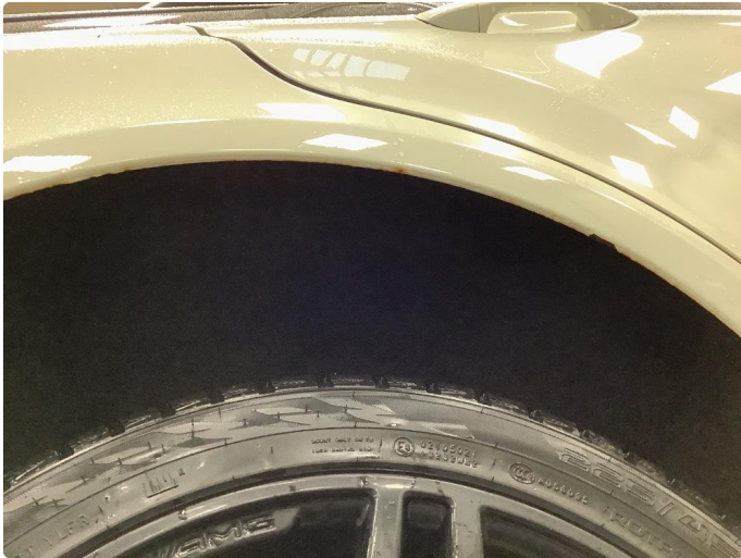
1.1 Noe steinsprut på hjulbue
