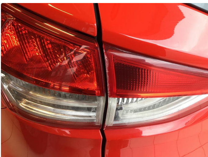
2.2 Liten sprekke venstre baklykt
