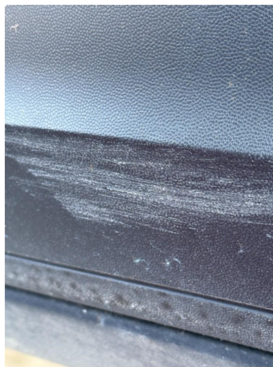
1.1 Litt oppripet i plastlist høyre foran
