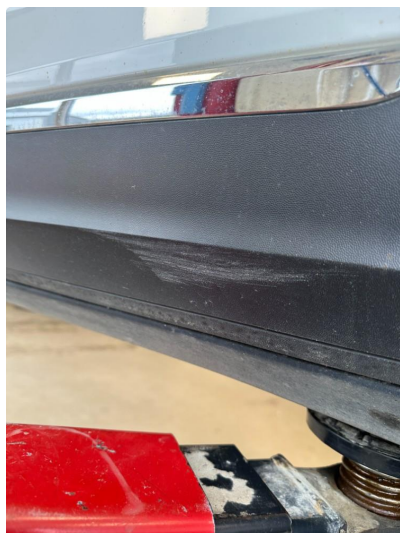
1.1 Litt oppripet i plastlist høyre foran
