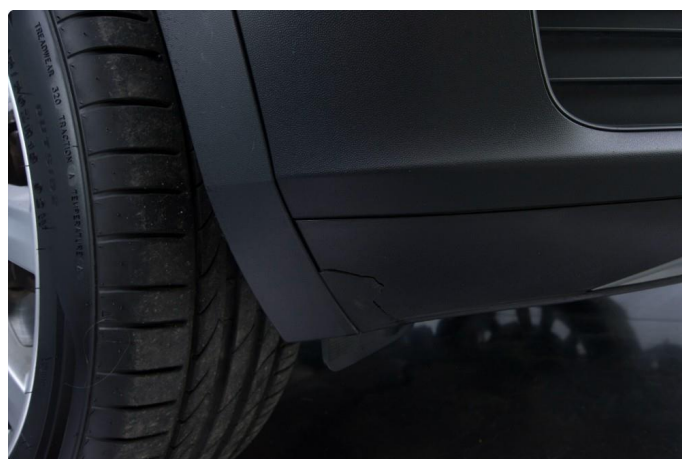
1.3 Liten sprekk i fanger nedre del
