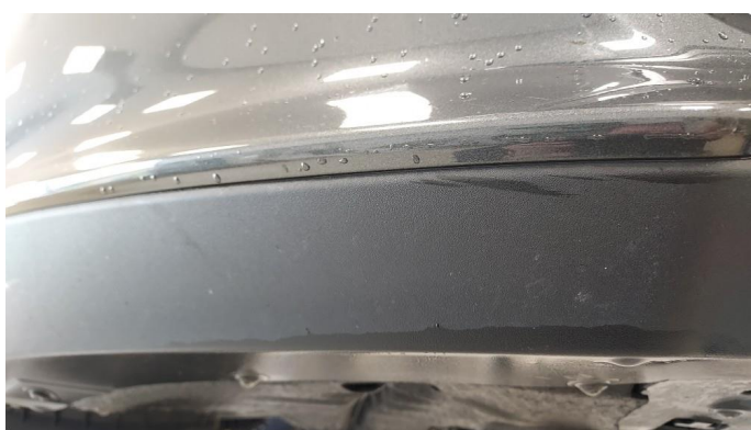
1.3 Noe oppripet på nedre del av fanger foran
