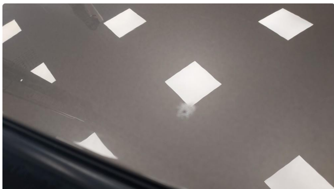
1.3 Noen steinsprut i forkant tak
