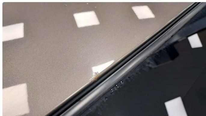
1.3 Noen steinsprut i forkant tak
