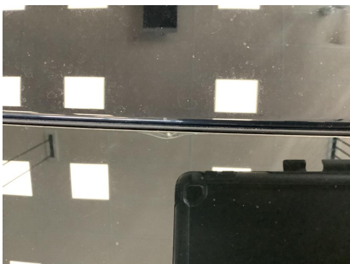
1.4 Steinsprut helt i kanten
