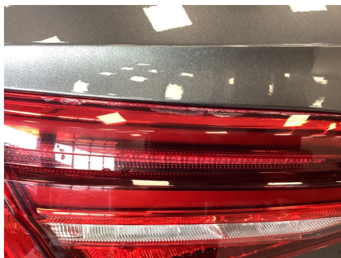
2.1 Litt krakelering i plast
