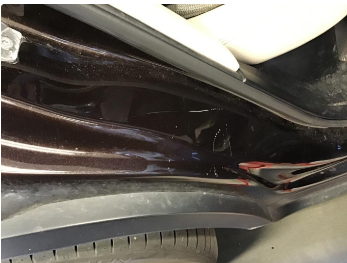
1.4 Slitasje i døråpninger
