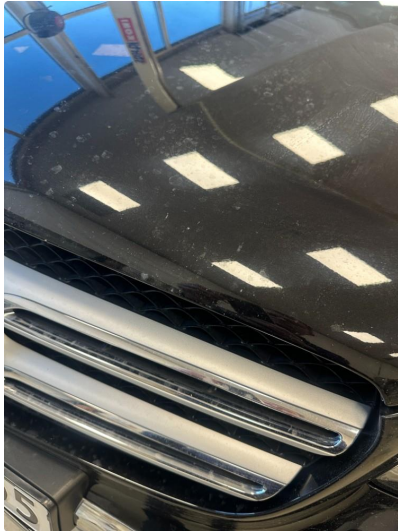
1.1 Noen steinsprut i panser. Normal slitasje
