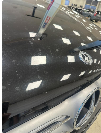
1.1 Noen steinsprut i panser. Normal slitasje
