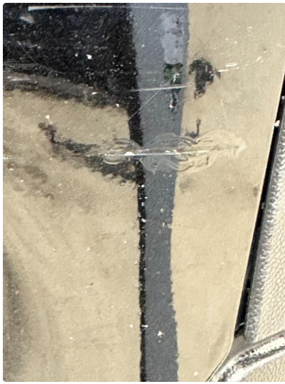
1.4 Ripe(r) ned til grunning i fanger foran. Lakkeres forenklet
