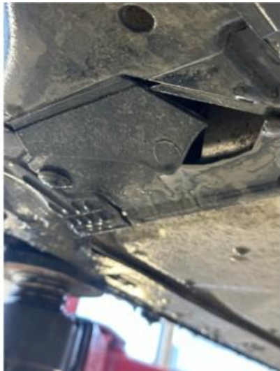
1.1 Sprekk i beskyttelsesplate under i bil
