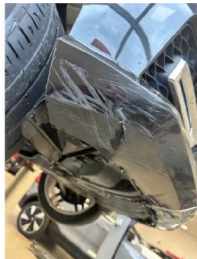
1.5 Noe oppripet på underside av fanger foran
