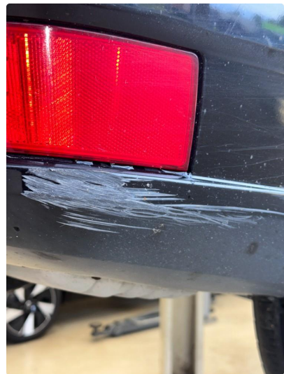
1.4 Skade i fanger høyre bak
