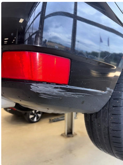
1.4 Skade i fanger høyre bak
