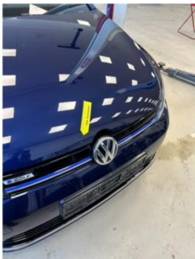
1.2 Noen steinsprut i panser
