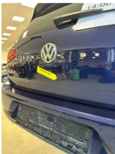
1.4 Liten bulk med lakkskade på bakluke
