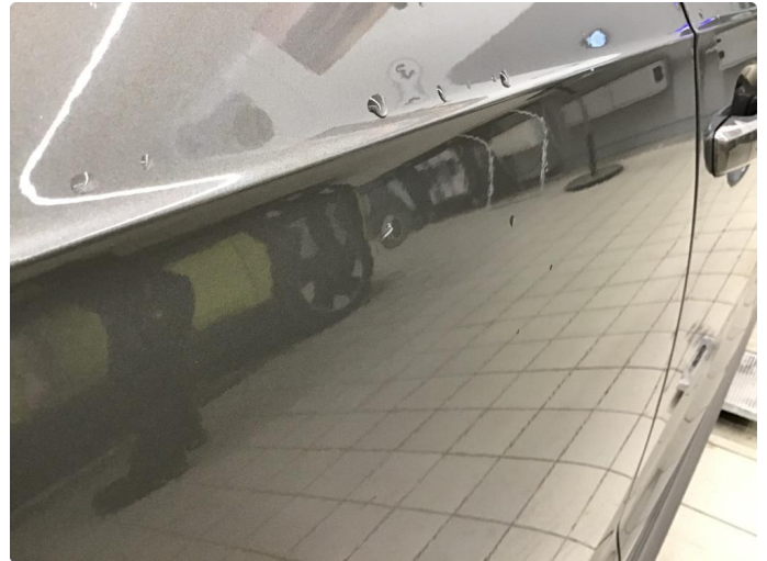
1.2 Noen bulker med lakkskader
