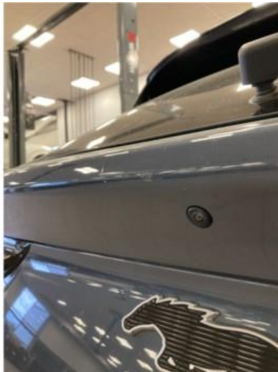
1.3 Liten skade i bakluke
