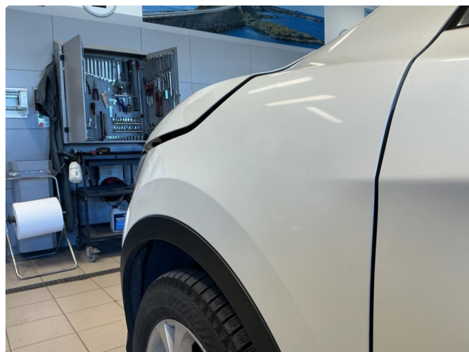
1.2 Bruksslitasje og steinsprut i henhold til alder.
