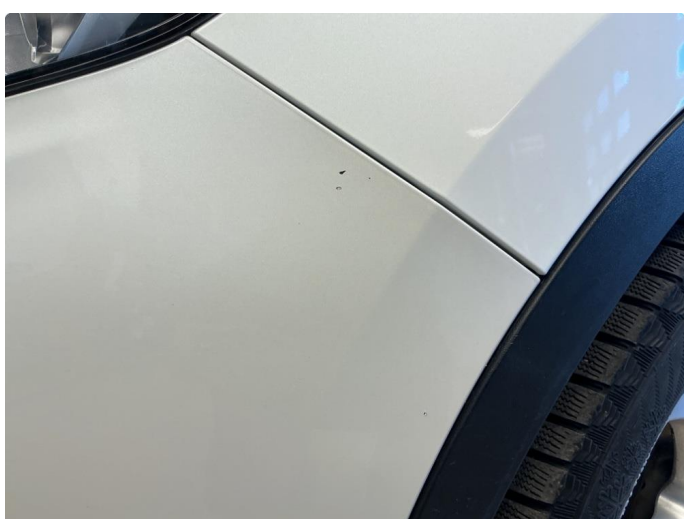
1.3 Små steinsprut frontfanger
