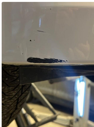
1.1 Litt oppripet på underside av fanger foran
