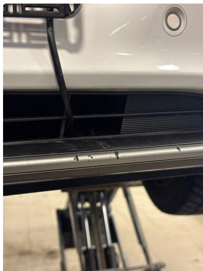
1.1 Litt oppripet på underside av fanger foran
