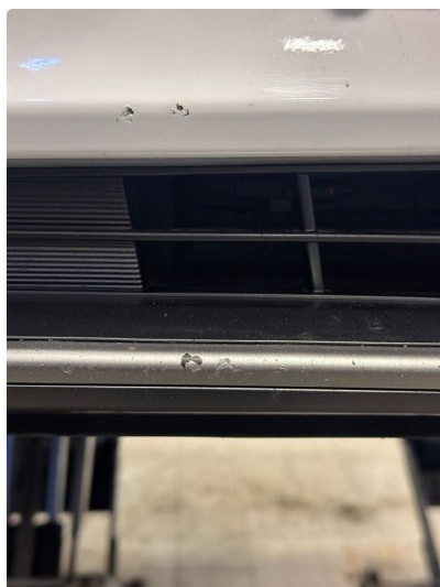
1.1 Litt oppripet på underside av fanger foran
