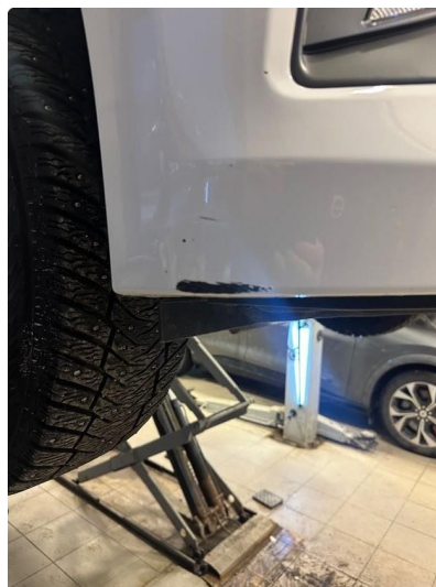
1.1 Litt oppripet på underside av fanger foran
