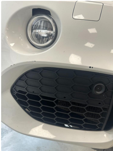
1.3 Noen hakk i fanger venstre foran
