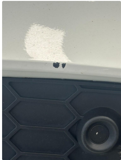
1.3 Noen hakk i fanger venstre foran
