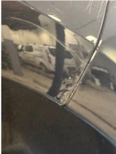
1.1 Liten antydning til rustdannelse på skjermer bak. Ubetydelig. Lakkeres forenklet
