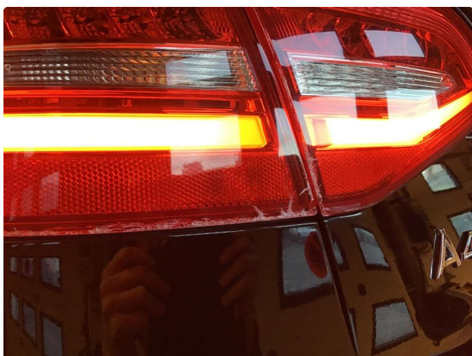
2.1 Defekt / sprukket glass
