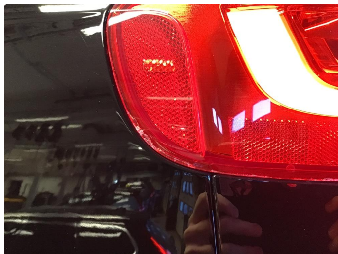
2.1 Defekt / sprukket glass
