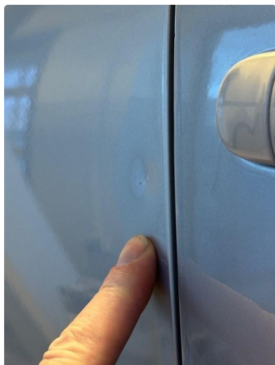
1.1 Liten p-bulk i dør høyre bak
