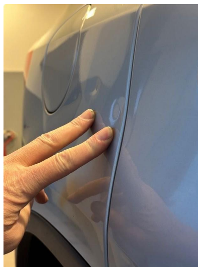
1.3 Noen p-bulker i skjerm høyre bak
