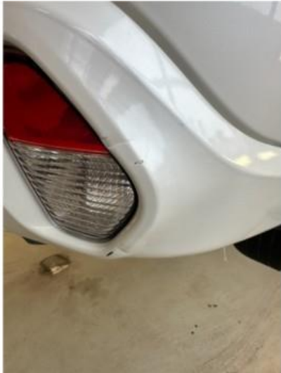
1.1 Noen lakkskader + en liten bulk i fanger bak
