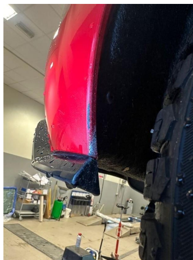
1.1 Noe steinsprut i hjulbuer begge sider bak
