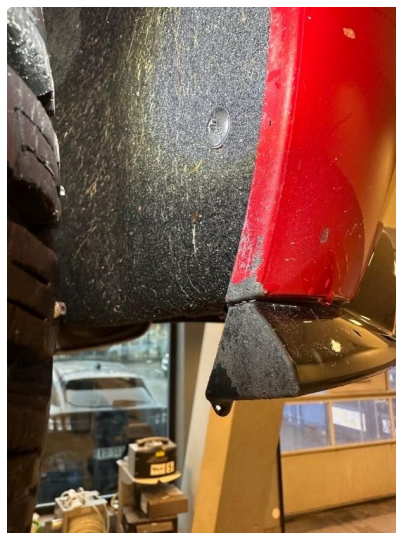
1.1 Noe steinsprut i hjulbuer begge sider bak
