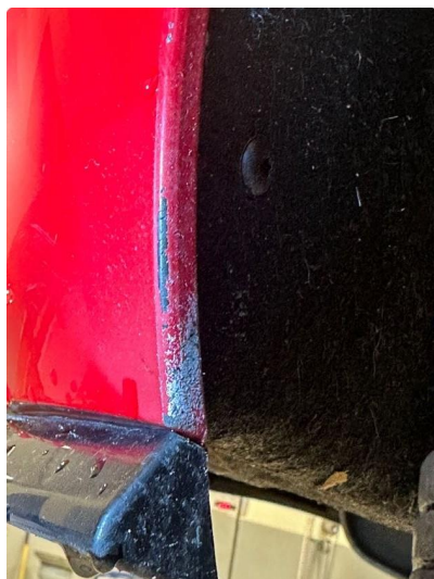
1.1 Noe steinsprut i hjulbuer begge sider bak
