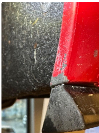
1.1 Noe steinsprut i hjulbuer begge sider bak
