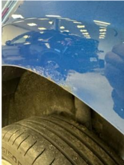
1.2 Litt påbegynnende rustdannelser i hjulbuer begge bak
