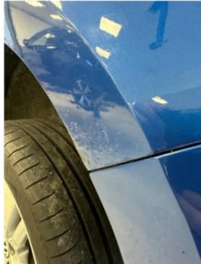
1.2 Litt påbegynnende rustdannelser i hjulbuer begge bak
