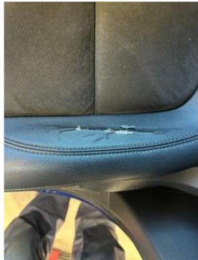
2.1 Skade i setetrekk venstre foran
