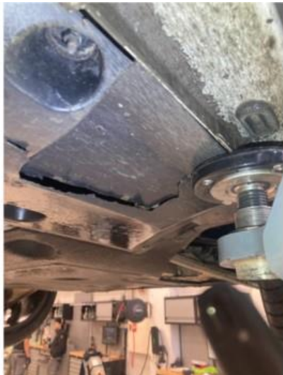
1.1 Sprekk i beskyttelsesplate under bilen.
