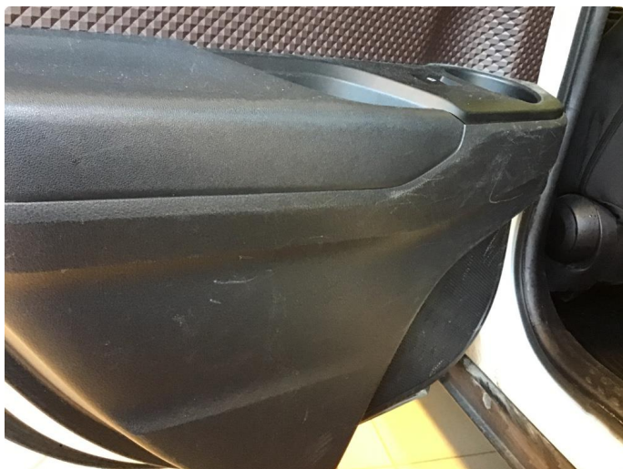
1.5 Bruksmerker/slitasje på innside av dør
