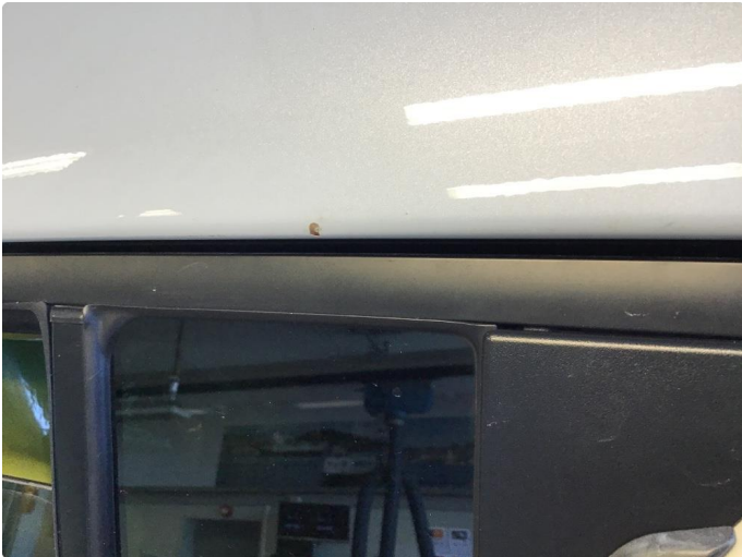
1.1 Liten lakkskade på venstre side av tak
