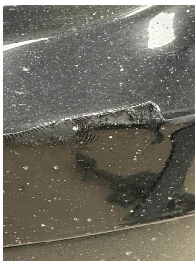
1.3 Liten skade i fanger venstre foran
