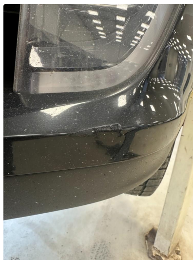
1.3 Liten skade i fanger venstre foran
