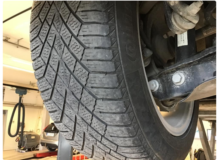
1.1 Begynnende stilasje på innside av dekk
