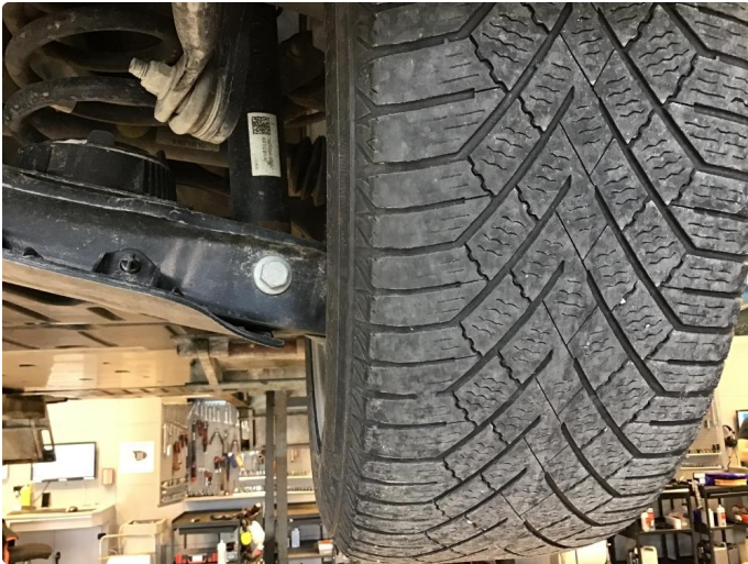
1.1 Begynnende stilasje på innside av dekk
