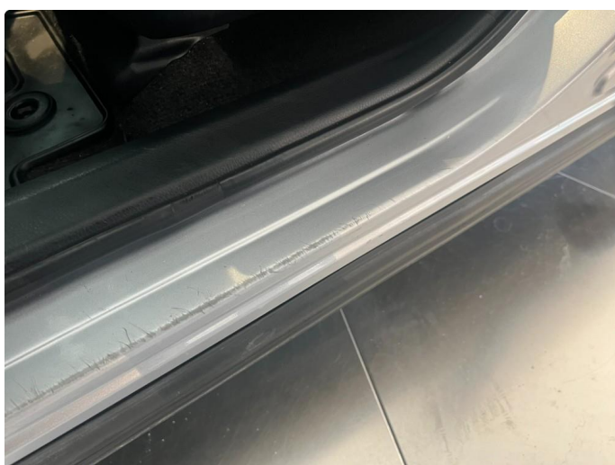
1.3 Noen riper i døråpning/dørterskel. Normalt iht. alder og kjørelengde.
