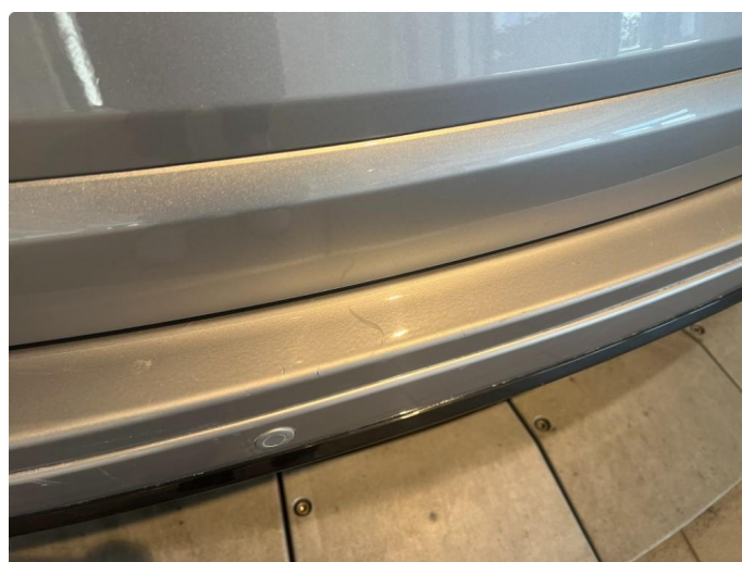
1.4 Noen merker innlastningssone støtfanger bak. Normal mengde iht. alder og kjørelengde.
