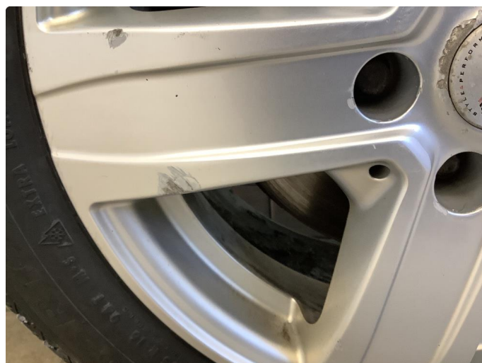
1.3 Liten skade på en felg
