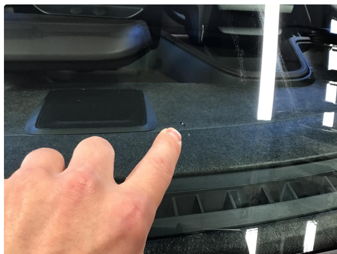
1.4 Steinsprut nedre del av vindu
