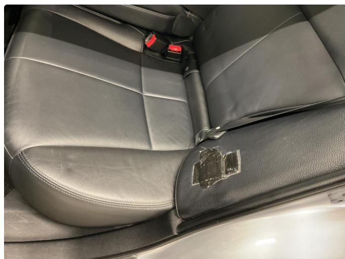
2.2 Skade på setetrekk
