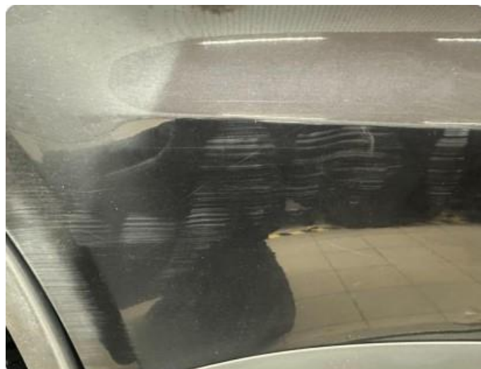
1.2 Bulk og riper dør høyre bak. Riper skjermutbygger.
