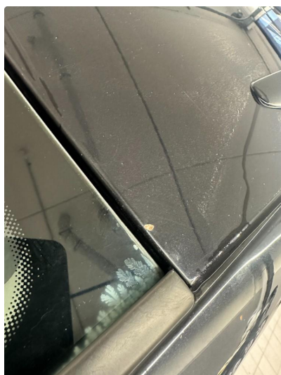
1.5 Steinsprut framkant tak.
