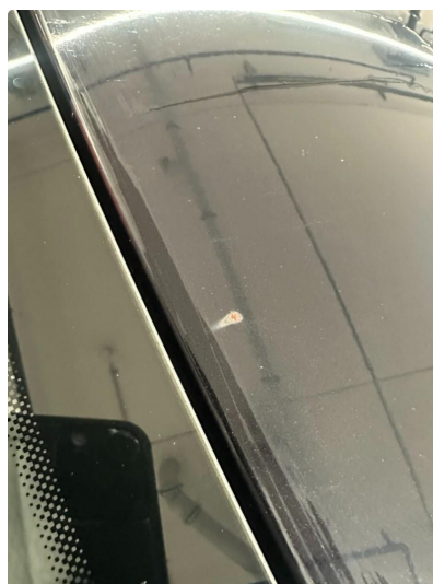
1.5 Steinsprut framkant tak.
