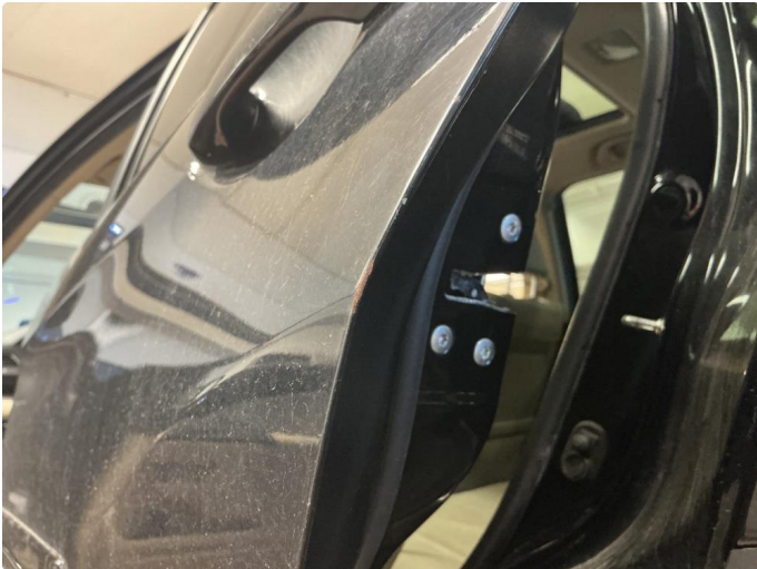
1.1 Litt rust på kan av dør, ved lakkavsliting
