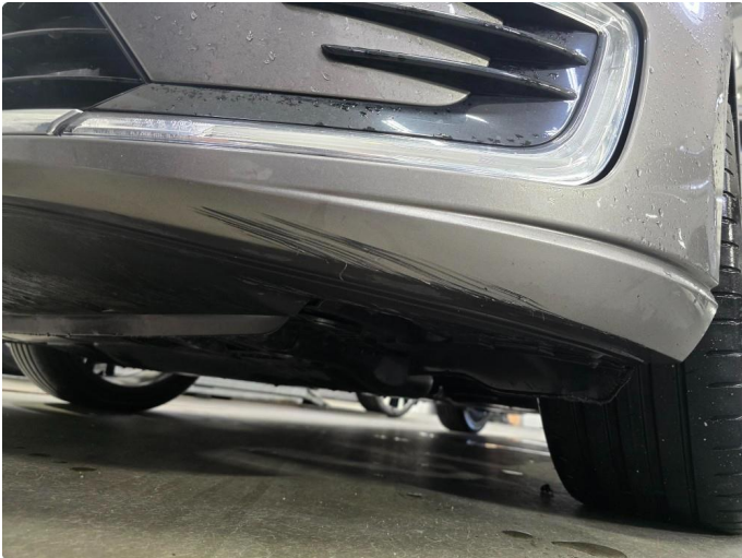
1.1 Lite skrubbmerke underkant fanger foran venstre side
