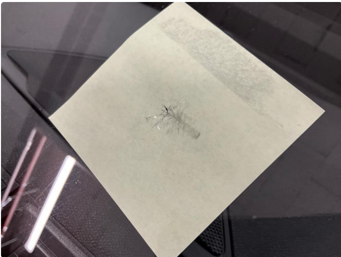
1.2 Steinsprutskade nede frontrute, denne er reparert.
