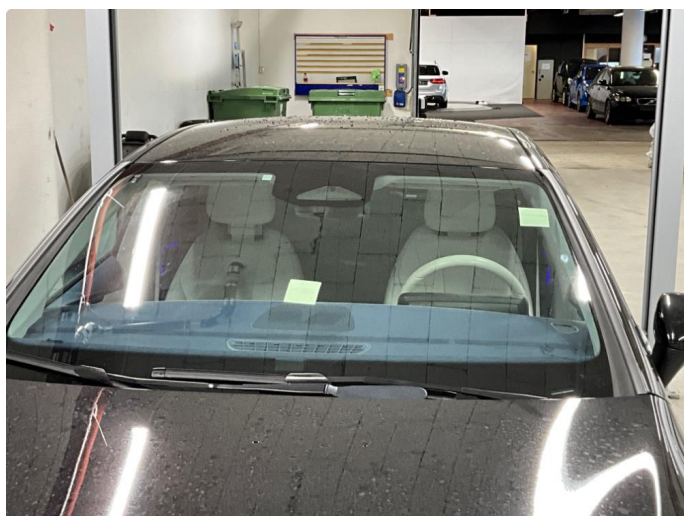
1.4 Steinsprutskader frontrute, disse er rep.
