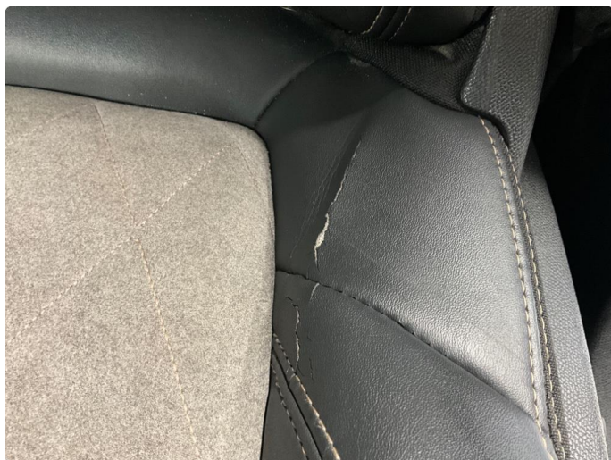
2.1 Skade på setetrekk
