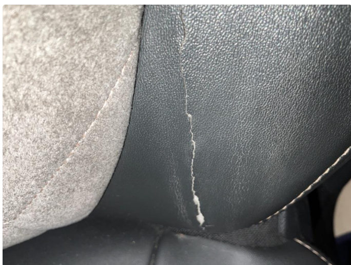
2.1 Skade på setetrekk
