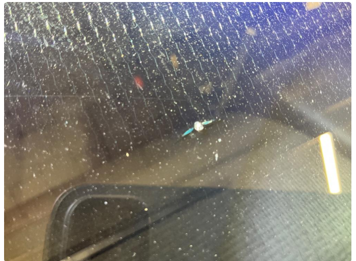
1.2 Steinsprut h. side frontrute, denne er reparert.
