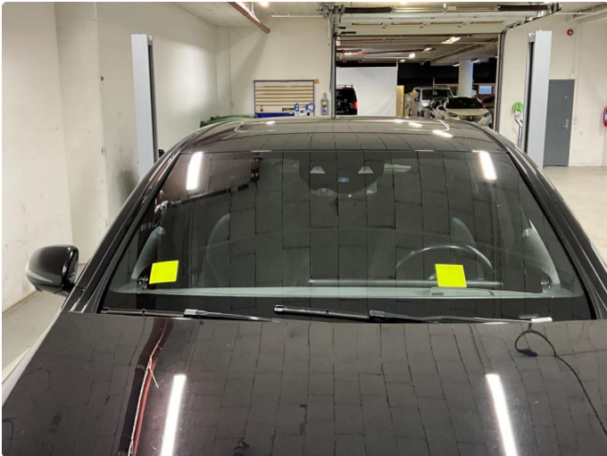
1.1 Steinsprutskader i nedkant frontrute, disse er reparert.
